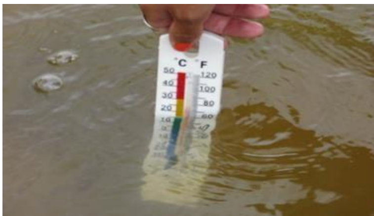
Figura 8. Medição de temperatura da água (Fonte: Zuleide Fernandes).
